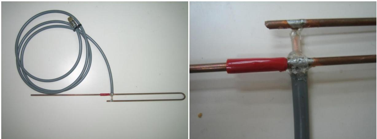
Fig. 4.2-5 輻射器用銅棒と同軸ケーブル
