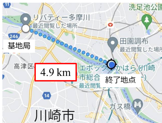
図6.10 通信距離試験
