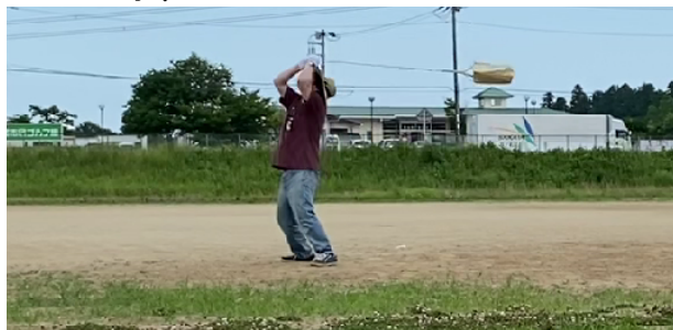
Fig. 6-3-4 遠心力で 10G をかけた様子
