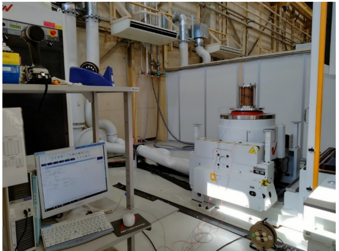
Fig. 6-4-1 実際の振動機 (茶色筒の中に CanSat 格納)
