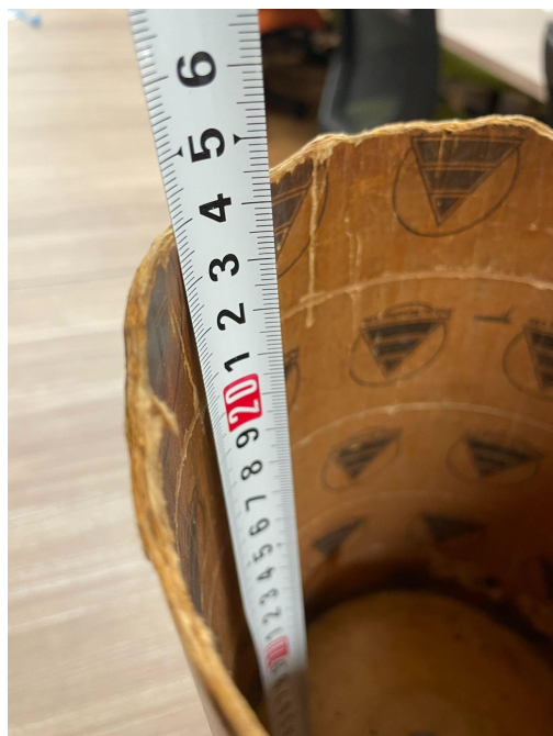
図6.2.1 キャリアの高さの確認
