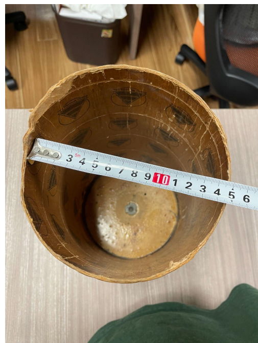
図6.2.2 キャリアの内径の確認
