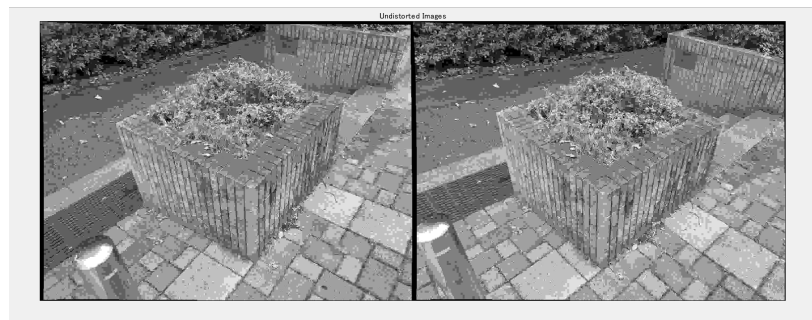
図6.13.2 2枚の画像のレンズの歪みの補正
