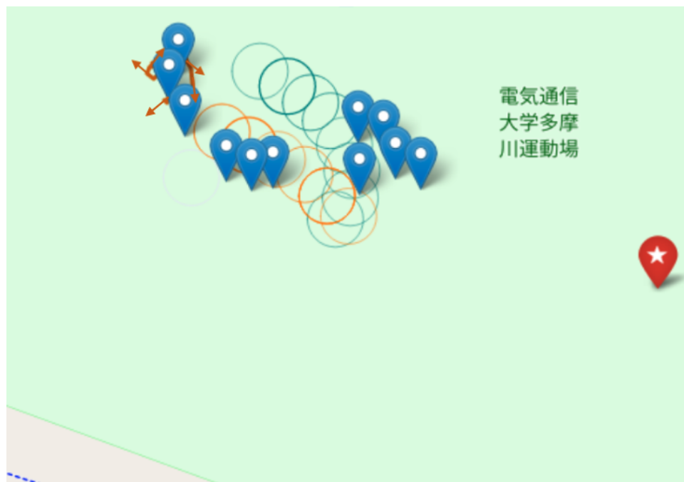
図 6.11.1 End-to-End試験1回目における子機の評価記録(子機別で青、橙、紫色の円)と導出した最適経路(青色ピン)と親機の走行経路(茶色の線)
