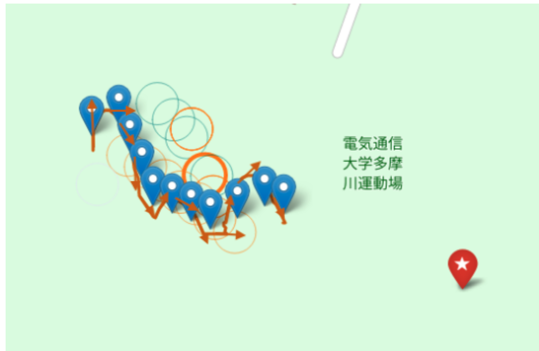
図 7.17.1 最良経路導出試験1回目における子機の評価記録(子機別で青、橙、紫色の円)と導出した最適経路(青色ピン)と親機の走行経路(茶色の線)
