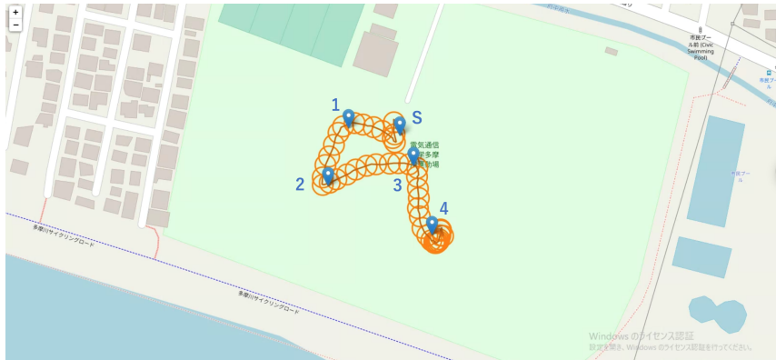
図7.21.1 親機指定経路走行試験の指定経路(青)と実際の走行経路(茶・橙)
