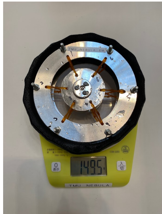
図45. 吸水後のタイヤの重さの様子
