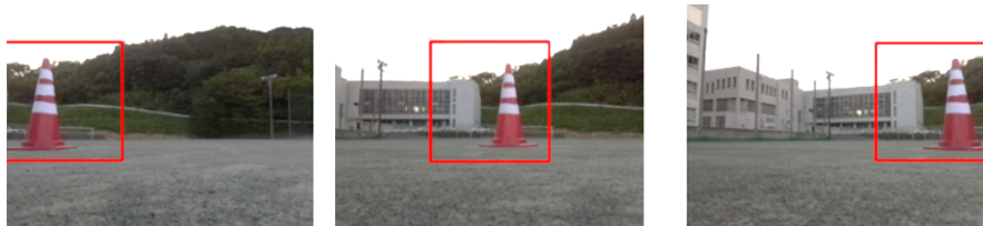
Fig.1-1 左右を判定するための 3 分割の画像分類の例
