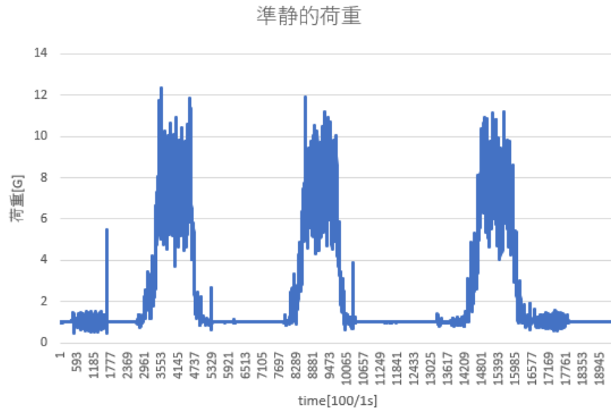
Fig. 6-5-3 加速度センサの数値（縦軸はかかった加速度[G]，横軸は時間[1s]）
