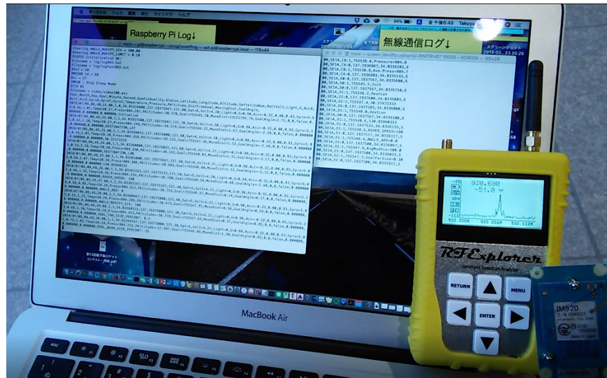
Fig. 6-8-1 電波 ON/OFF を目視で確認するための実験機器
