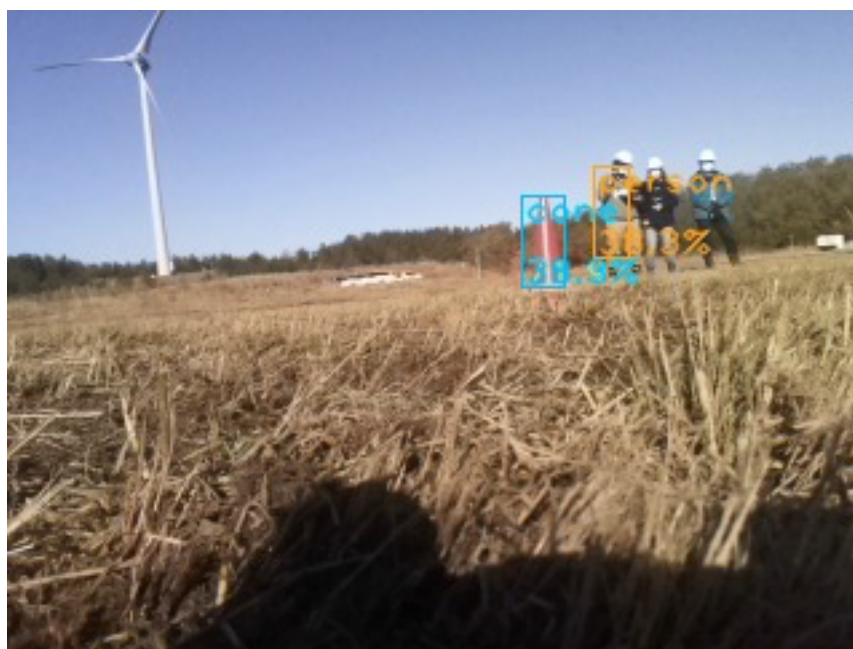
Fig. 遠方から画像どの位置でも人間(オレンジ)とゴール(水色)を認識している認識結果
