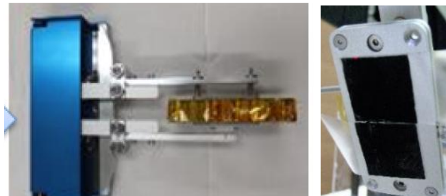
ヤモリ足裏構造を模倣した太陽電池パドル捕獲機構
