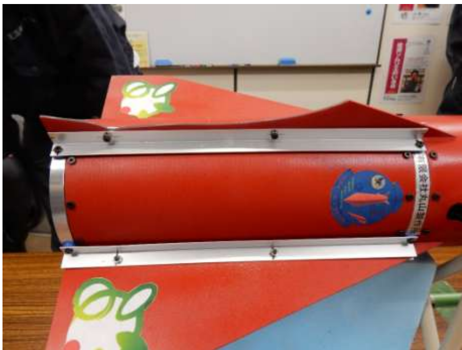
図 3.1.14 破損したフィンおよびモータモジュール(側面)
