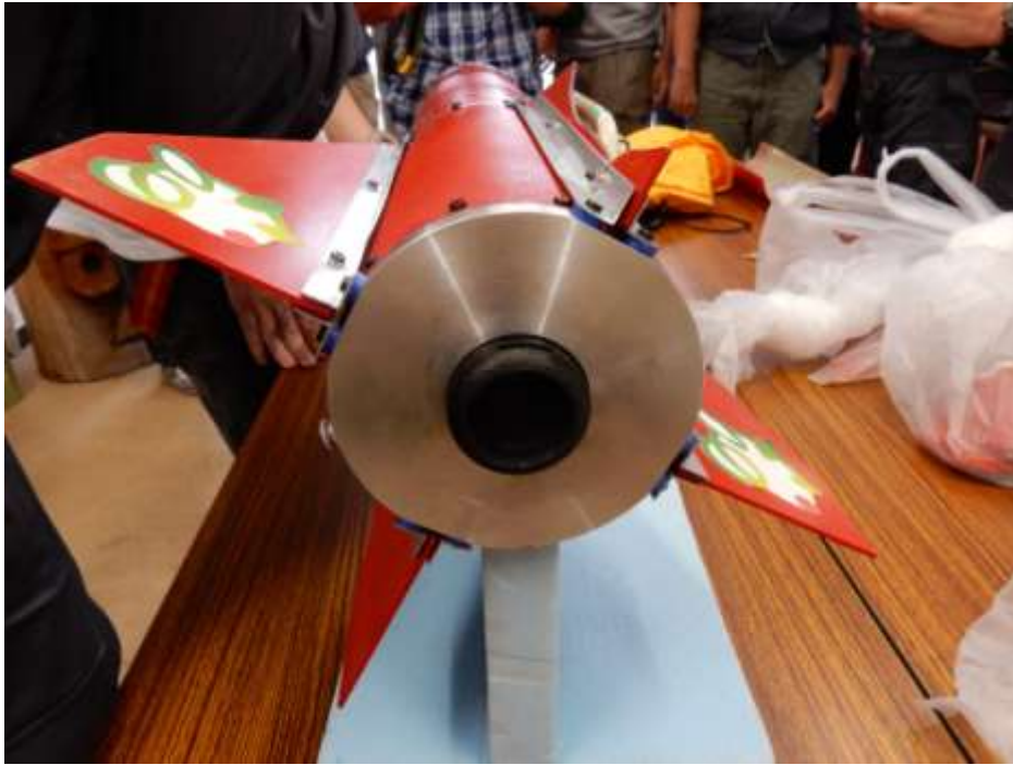
図 3.1.15 破損したフィンおよびモータモジュール(背面)
