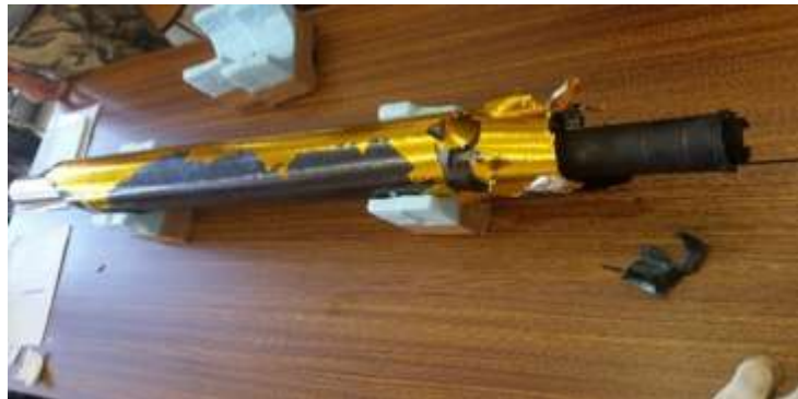
図 15 飛行後のボディチューブ
