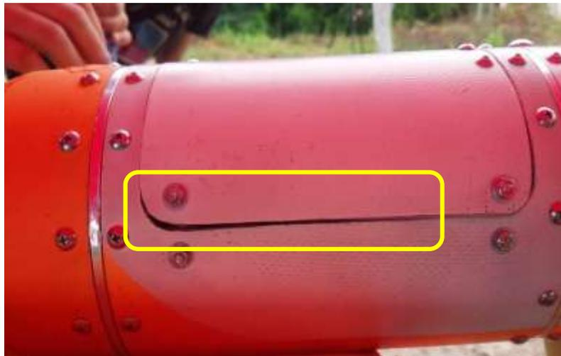
図 3.2-9 扉の隙間(機体左方側から)
