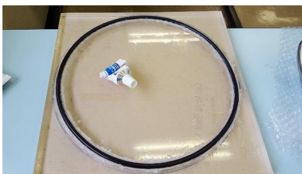
図 4.38.2.2-3 自作した真空装置の蓋
