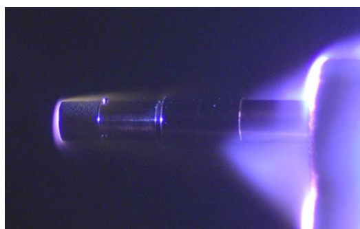
図 4.23-3 人工流れ星を用いた高層大気観測に関する研究（アーク加熱風洞実験の様子）
