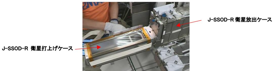
JEM 船内での J-SSOD-R における軌道上装填作業の様子
