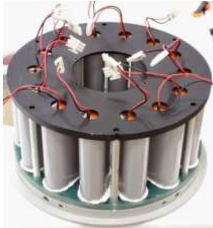
図 9 電池組み付け部分
