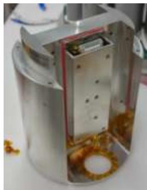
図 8 電子機器を搭載するピラー
