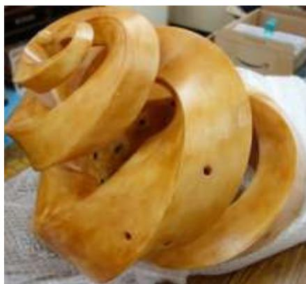
図 5 3D プリントにより作成された彫刻部
