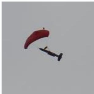
図 26 NINJA-S のパラフォイルのコントロールラインの機体への絡まり
