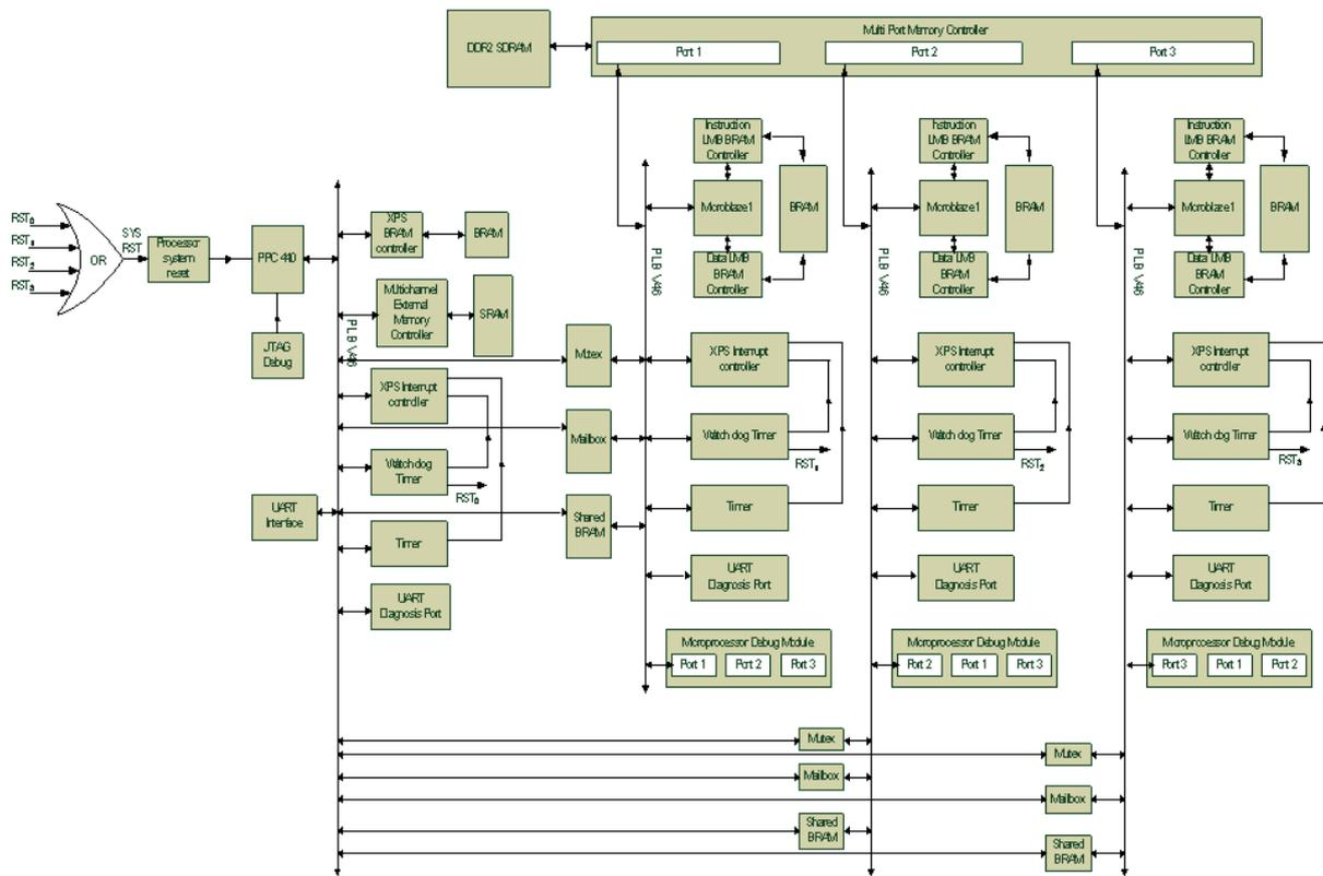
Fig. 9. FPGA Multi-Processor System-on-Chip Architecture.
