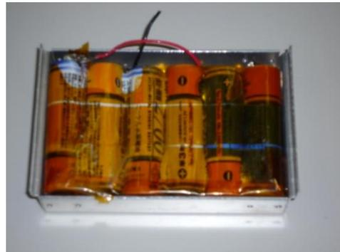
図 10 電池の全短絡試験
