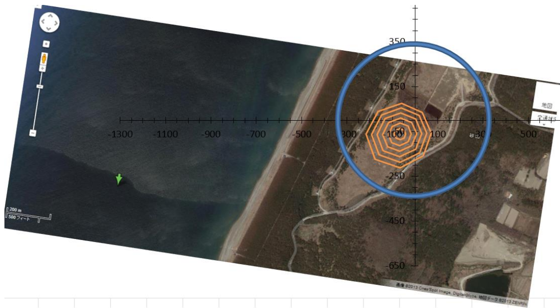
図 3.5.38 缶サット落下予想範囲 打上げ方位 223° 打上げ仰角 78° 風速 0~6 m/s
