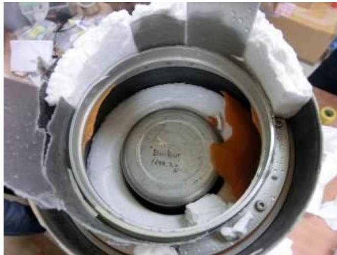
図 3.1.6 N_2O タンク上部の機体の破損状況
