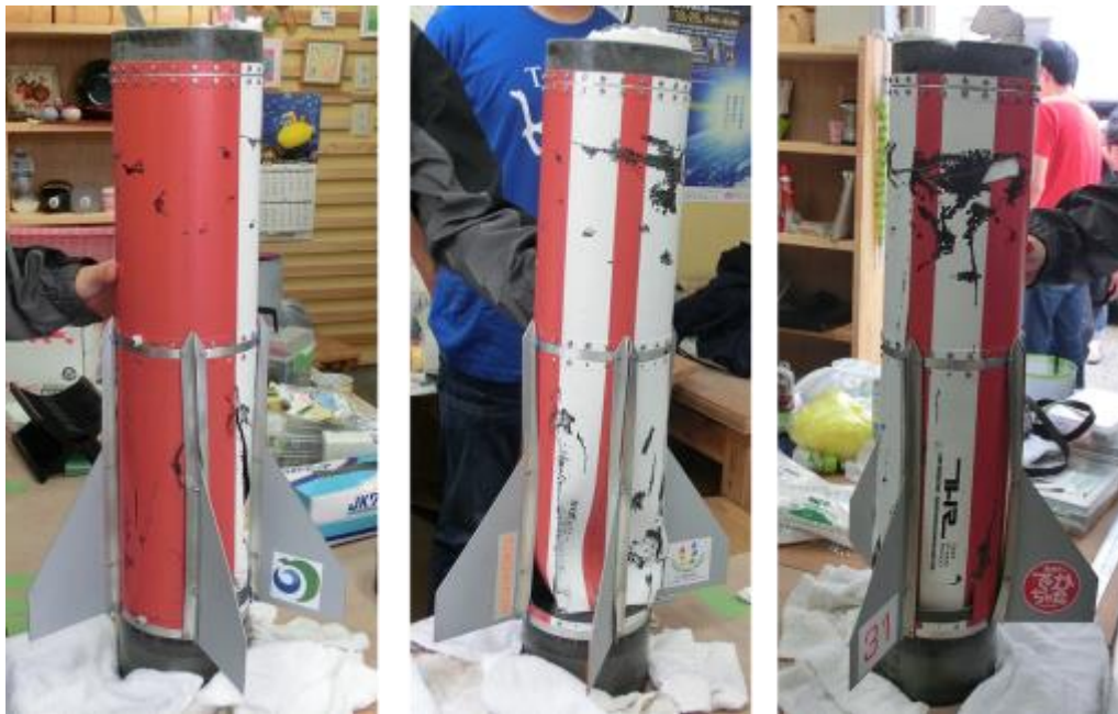
図 3.1.7 モータ部分の損傷状況
