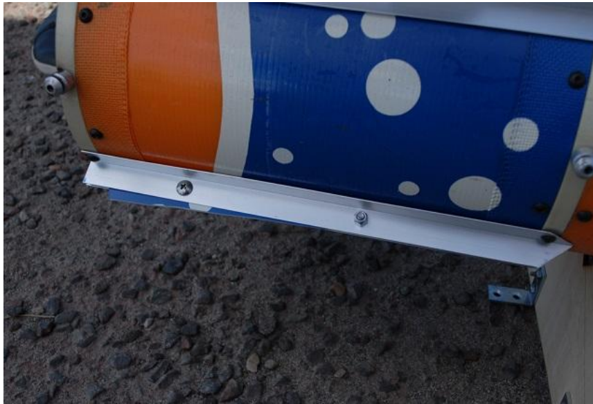
図 3.1.5 フィン破損状況
