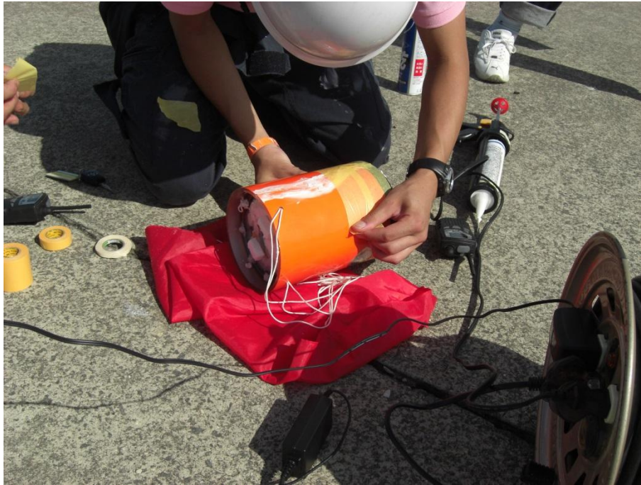
図 3. 5. 31 手順④ マスキングテープを張り破損部を保護する様子
