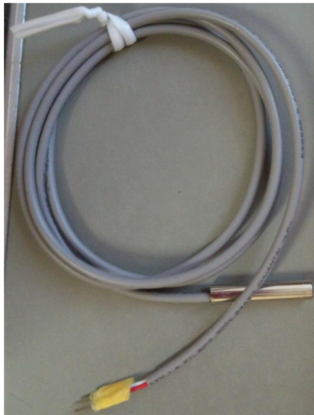
図 3.4.13 海水温計測センサー(DS18B20)
