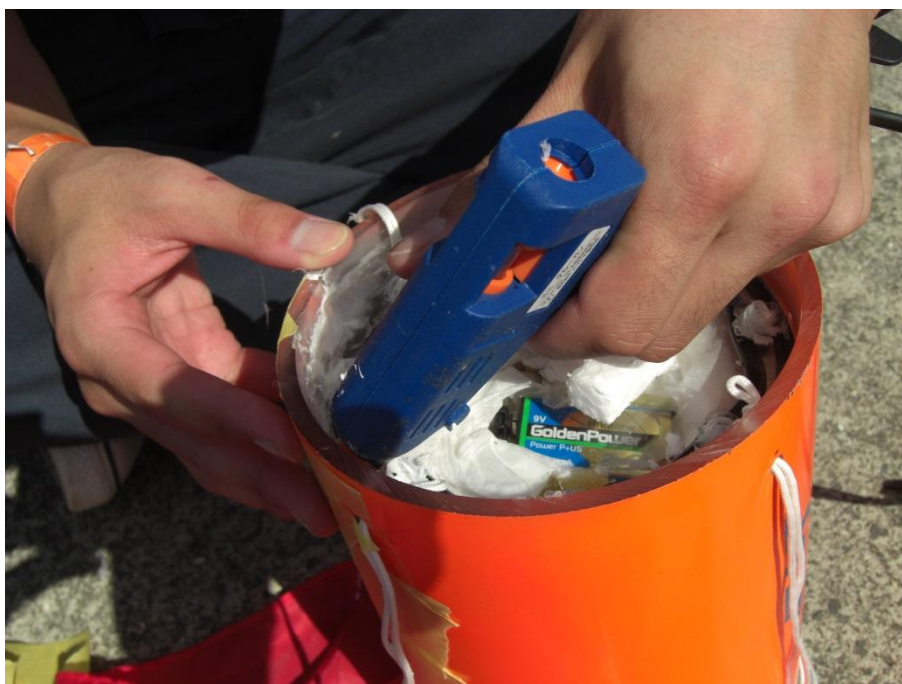
図 3. 5. 30 手順③ ホットボンドを亀裂を覆うように塗る様子
