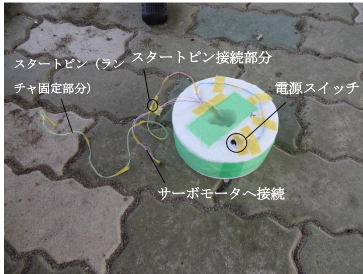
図 3.4.9 保護ケースに入れた分離回路
