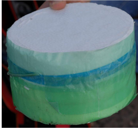
図 3.4.4 海用計測回路防水ケース
