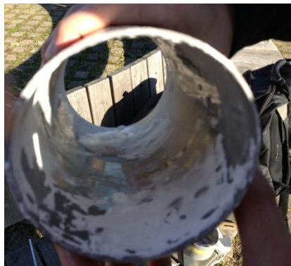
図 3. 5. 14 試験機②試験後機体内部
