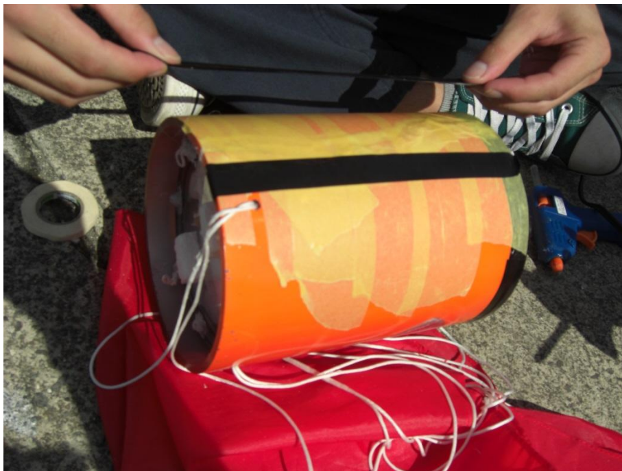
図 3. 5. 32 手順⑤ ビニールテープをマスキングテープの上から張る様子
