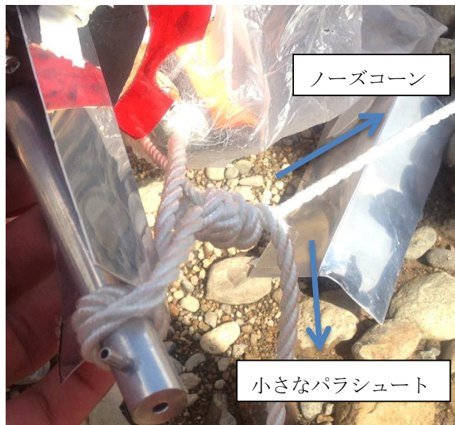
図 3.3.3 2 本のショックコードが絡み合っている様子
