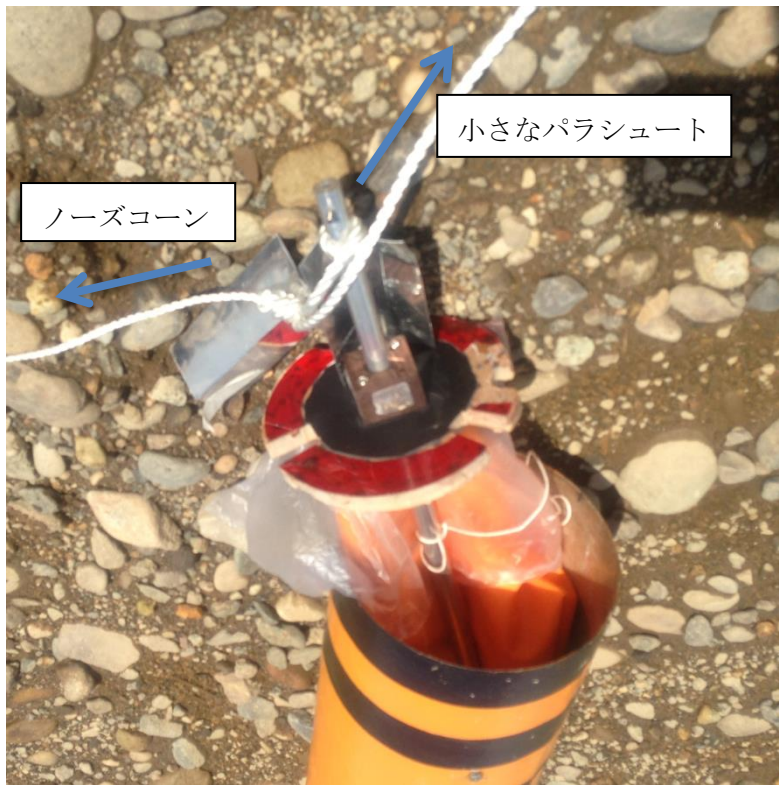
図 3.3.2 機外に出た回転系と絡み合った 2 本のショックコード
