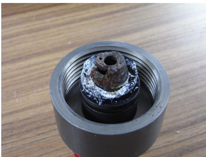
写真 3.2.1 インジェクターベルの破損状況
