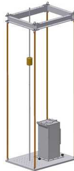
図垂直(Y軸方向) 衝撃印加時
