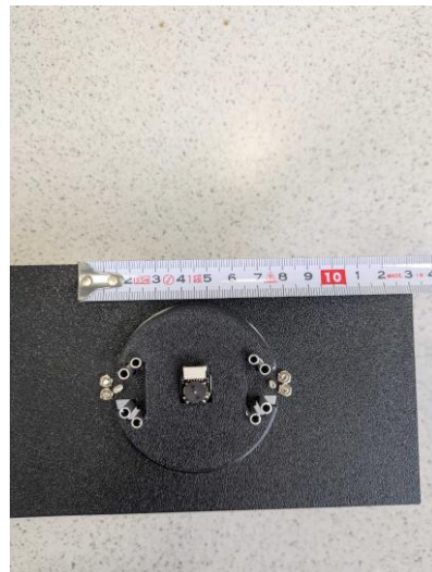
図 4.19 円筒カム機構外観 (上) 親機とはカムフォロアを介してねじで締結する。
