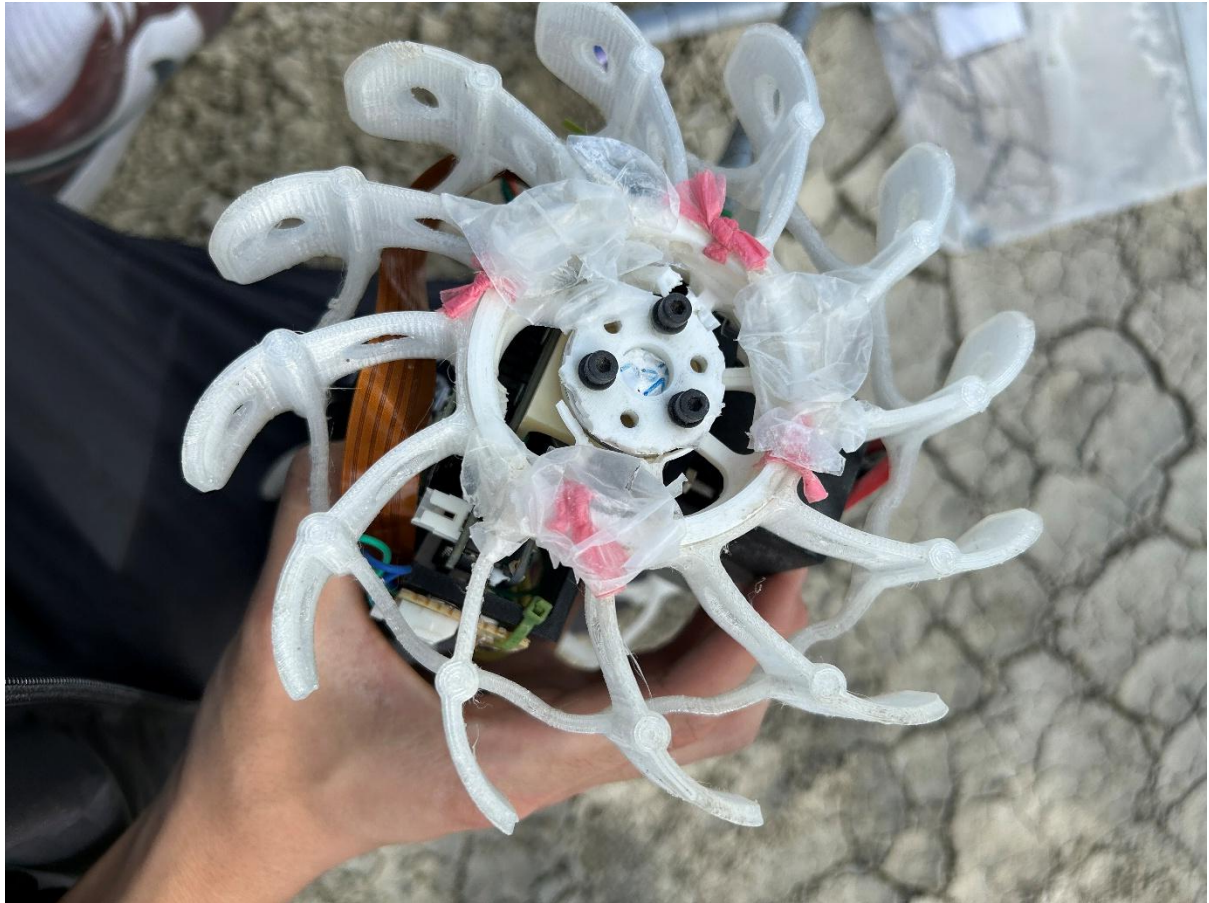
図 4.11 上下機構（上左：正面から見た外観，上右：上から見た外観，下：構成する部品）
