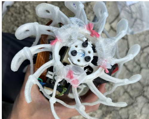
図 7.1 スポーク部が破損した様子
