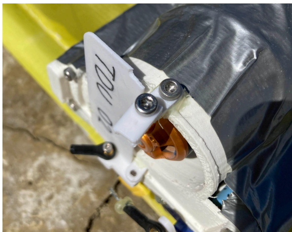
図7.4.1.1 1回目の打ち上げによるラダーの破損
