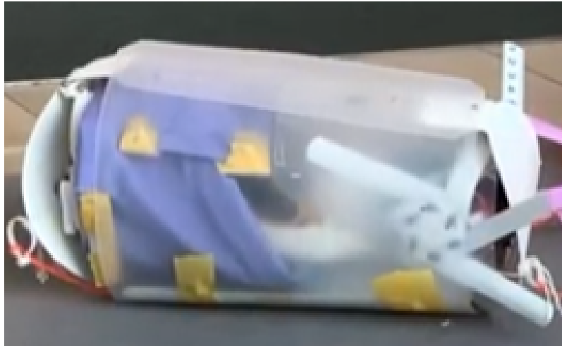
図4.3.1 ロボタ2機収納時のCanSat内部 (左Aパーツ, 右Bパーツ)
