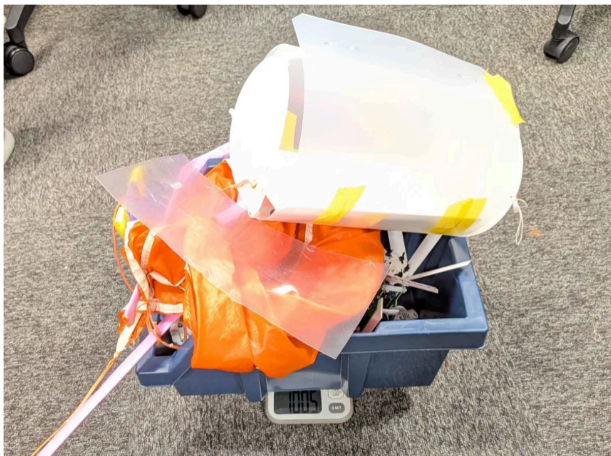
図 5.1 A,Bパーツ パラシュート ケース 搭載物すべてを含めた質量
