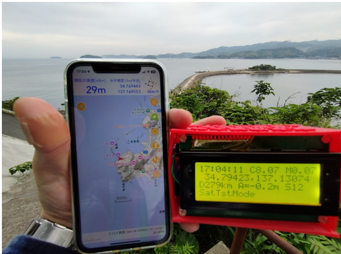
Fig.5-3-5 受信機で実際に取得した座標データ (右の受信機から、送信機座標が表示)
