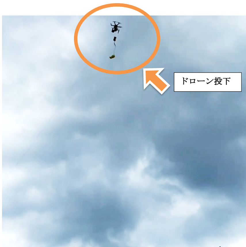
Fig.5-4-1 落下試験のドローン投下
