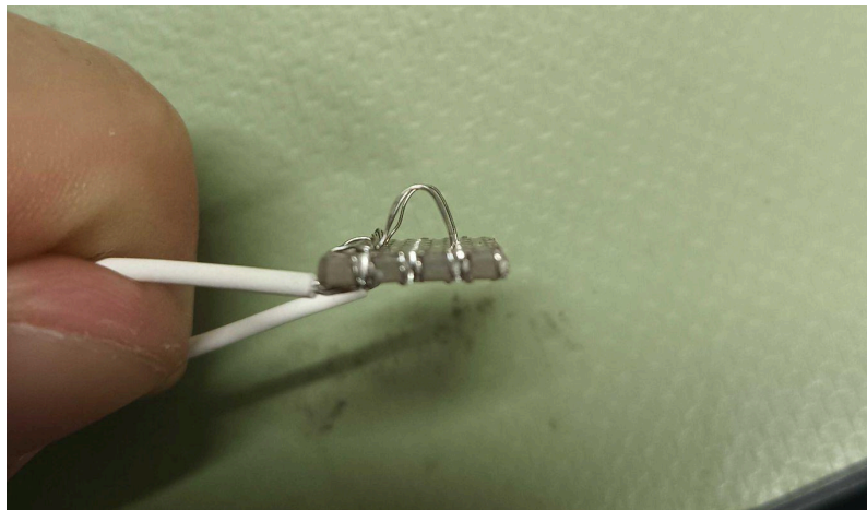
治具を用いて製作した溶断基板の再現性の高さ
