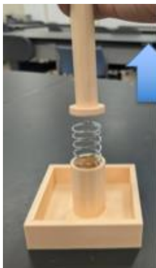
図 4.2.9 軸と本体の接続の写真(ばねを解放した直後の写真)
