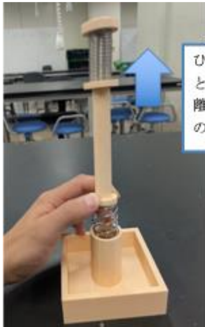
図 4.2.13 軸に取り付けられたばねと移動円盤の写真(ばねを解放した状態)
