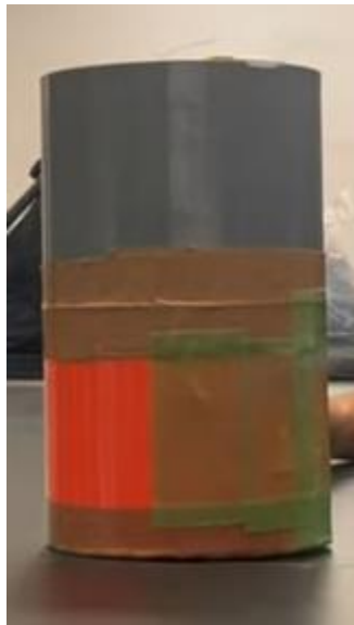
図 5.1.3 CanSat をキャリアに搭載した状態
