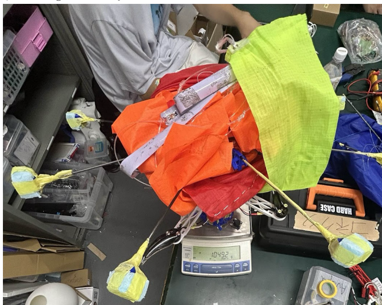
図 5.1.1 CanSat 本体とパラシュートの合計質量
