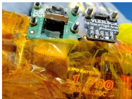
Fig.7-2-2 ラズパイカメラの外れ
