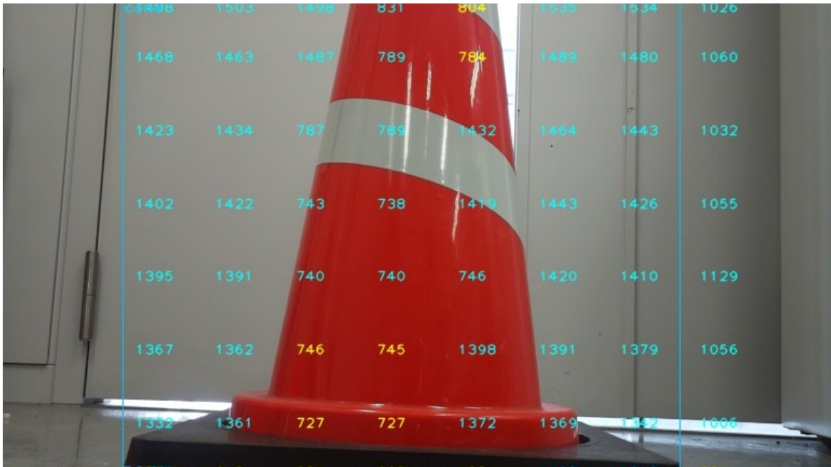
Fig.11-3 ToFカメラ深度情報とObjectDetectionでゴール認識できた画像の例
