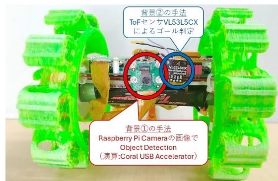
Fig.1-7 今回行うミッション：カメラ画像によるObject Detection+ToFセンサによる実測距離の2つのカメラを用いる正確なゴール認識
