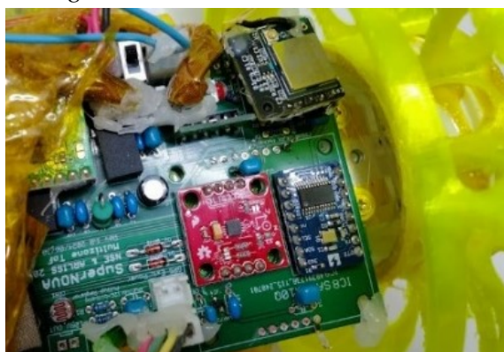
Fig.7-2-3 回路端のLoRaとGPSの端子折れ
