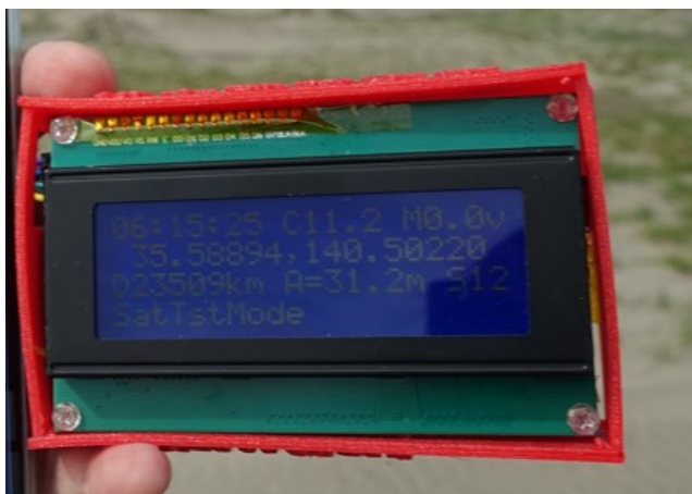
Fig. 5-3-1 LoRa受信機(LCDでログ表示)
