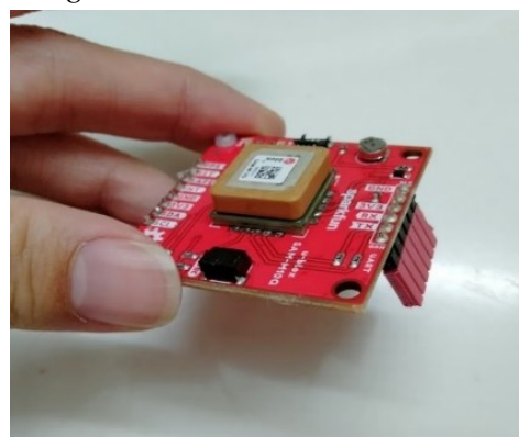
Fig.7-2-4 GPSの端子折れ
