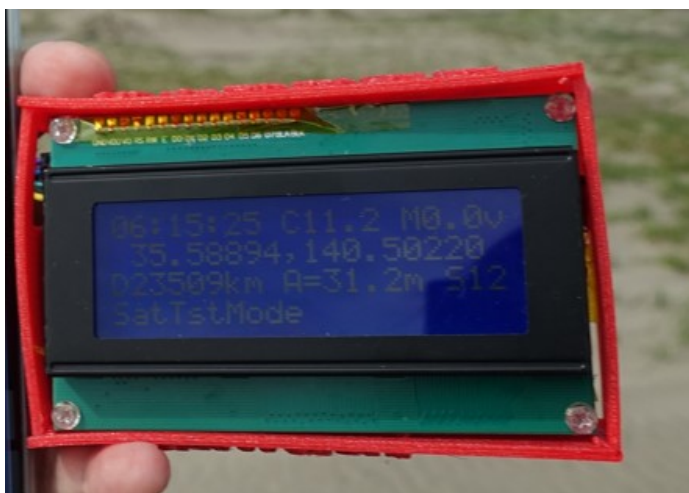
Fig. 5-9-1 LoRa受信機(小型受信機)
