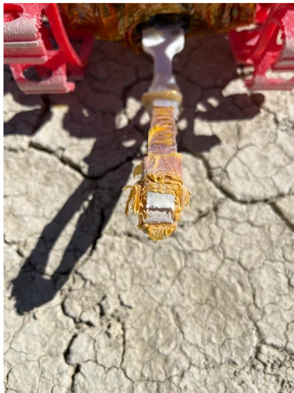
Fig7-2-6 スタビライザーの破損の様子
