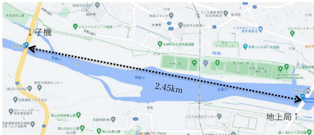
図5.7 長距離通信試験におけるCanSat子機と地上局の位置関係
