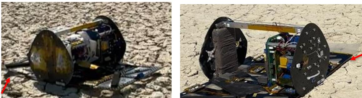
図7.13 1回目のミッションからの改良（クリアファイルの装着）
