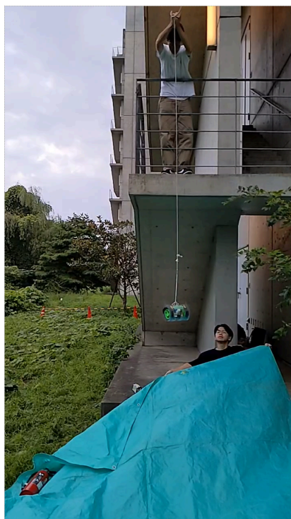
Fig 5.1.7.1 糸が張る直前8.67 (m/s)の速度が出ているコマ
