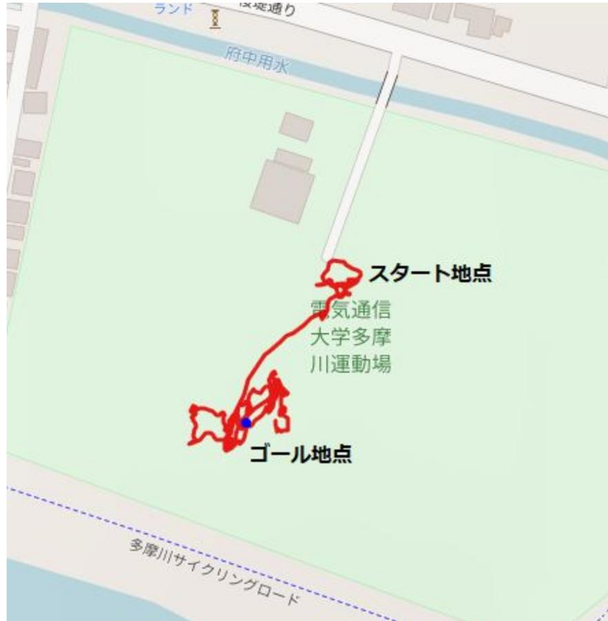
図6.18.1 GPSセンサ搭載CanSatのGPS座標ログの地図上プロット
