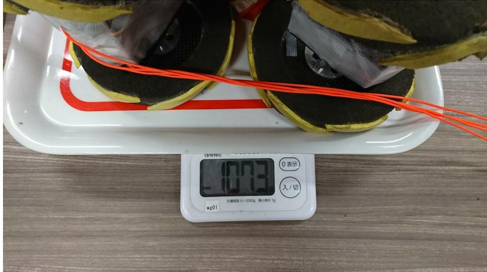
図6.4.2 パラシュートおよびモックアップ機体の質量
