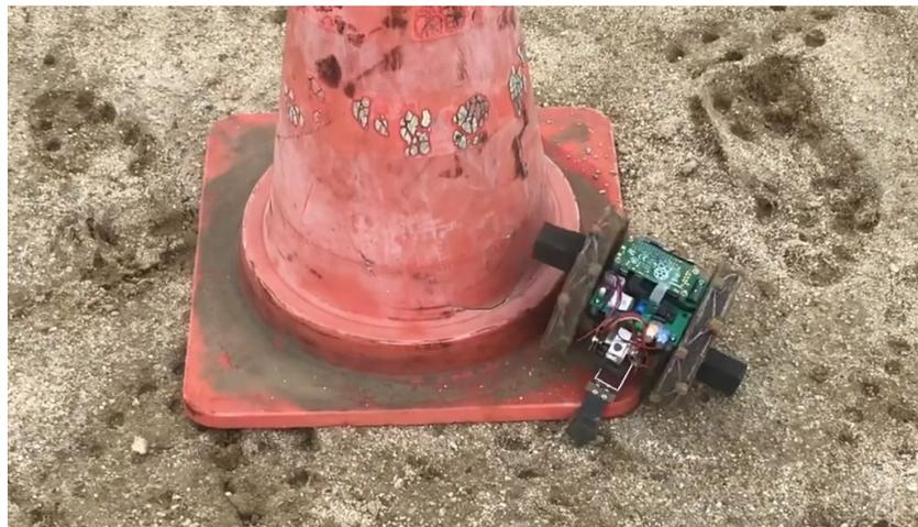
図6.17.1 ゴールコーンへスタックしたカメラ搭載CanSatの様子
