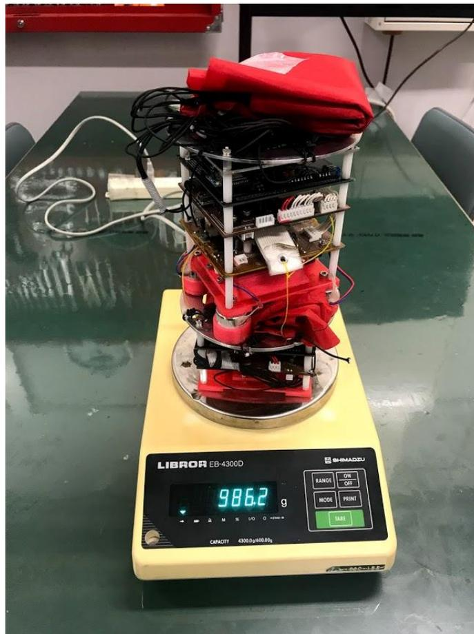
図1 質量試験計測時
