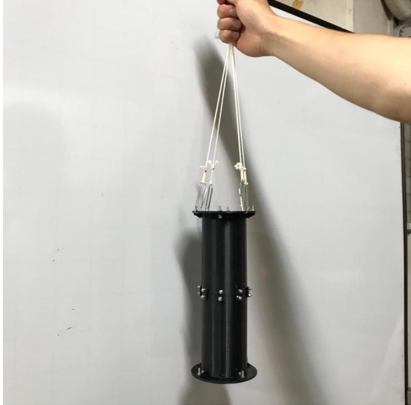
図 6-7 静的荷重試験用の容器
