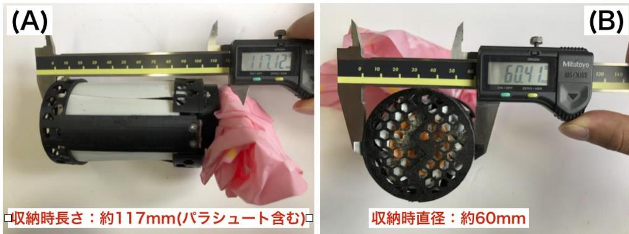
図 4-4 CanSat 外観図 (収納時)
