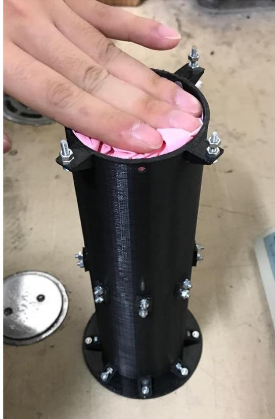
図 6-3 CanSat とパラシュートを 2 機分，収納容器に収納した様子
