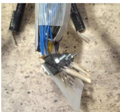
この **CanSat** にはミッションのための圧電素子がスタビライザについている。この圧電素子は曲げることで発電するのだが、曲げすぎてしまうと折れてしまうという問題があった。そのため左図のようなクラフトシートの壁とバネを用いることで、圧電素子が適度に曲がりかつ曲がり過ぎない構造にした。この構造によって圧電素子は壊れることなく長時間発電できるようになった。
