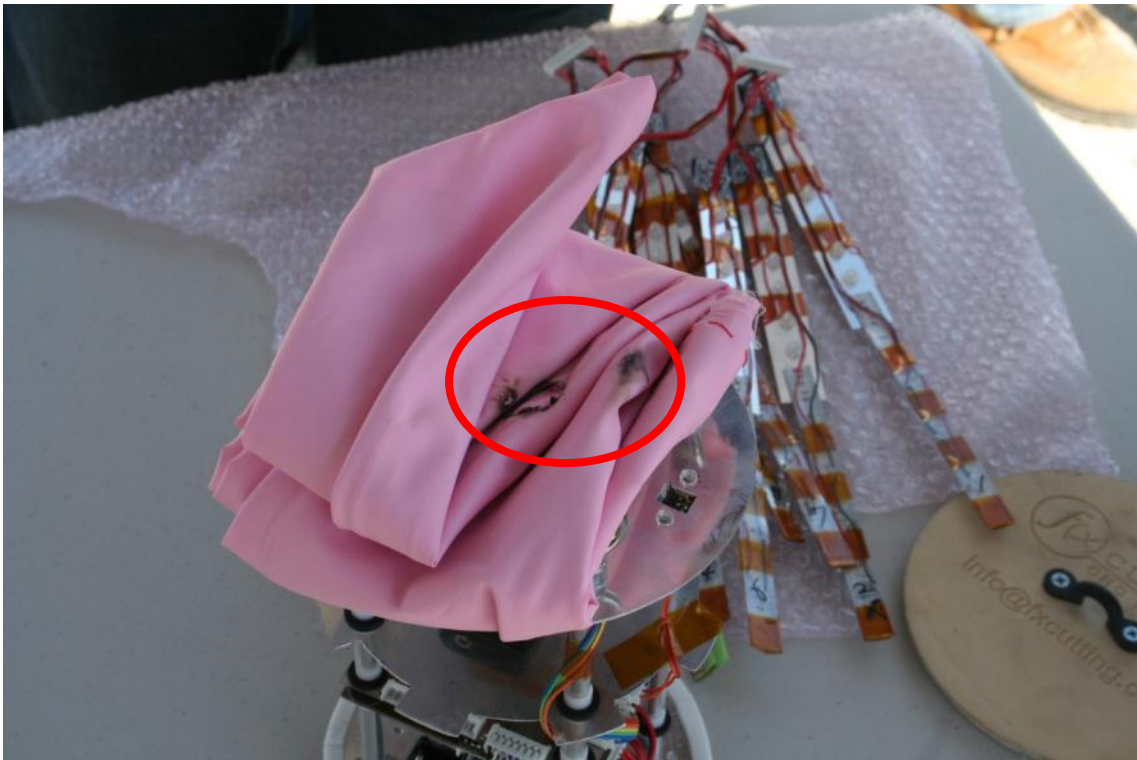
図 8 高温ガスで損傷したパラシュート
