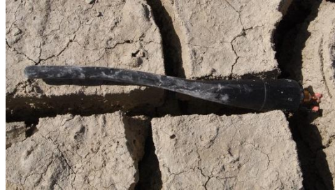
図 49 2 nd Flight 直後の親機：左が曲がった天板，右が折れたアンテナ
