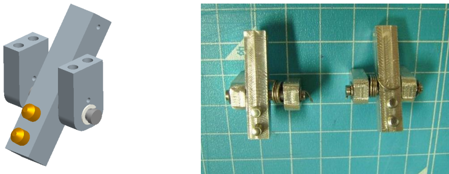
図 10 親機・子機分離機構の CAD(左)と試作品(右)
