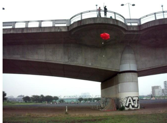
図 24 パラシュート展開確認試験@丸子橋
