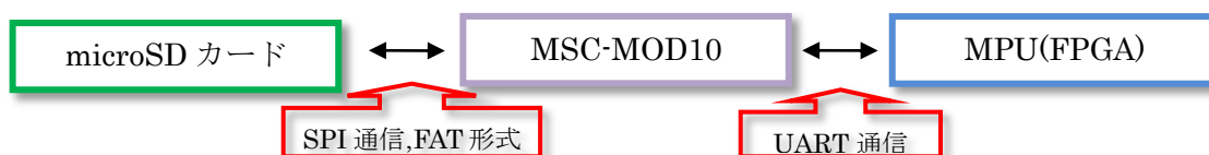
図 42 microSD カードとの通信方式
