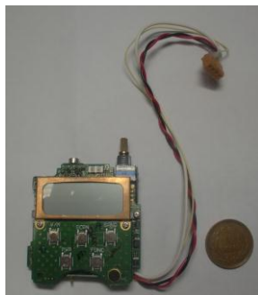
図 28 衛星載用改造済み無線機(DJ-C7)
