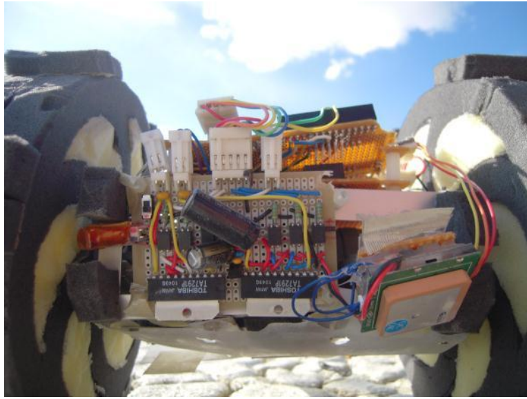
図 9 落下衝撃で壊れた基板
