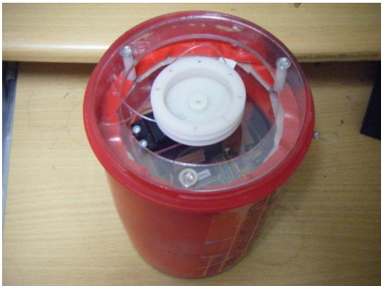
Fig.8 塩ビ板をはめ込んだ様子
