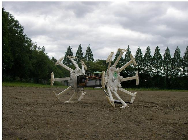
図 1. 展開車輪型ローバー「WindMill-II」
