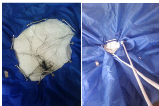
図1 パラシュート上部の穴の形状 穴の紐を引っ張ることで穴の大きさが変化する
