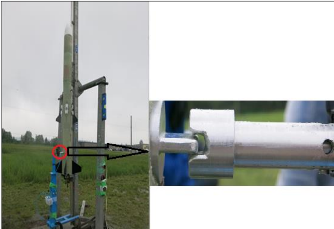
写真VI: アダプターとアームのかみ合わせの調整
