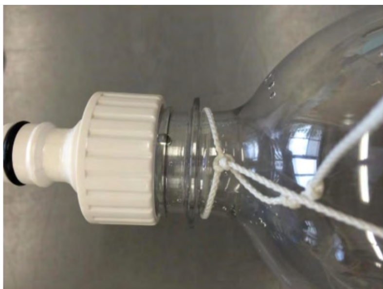
図 4.4 紐と水ロケットの接続
