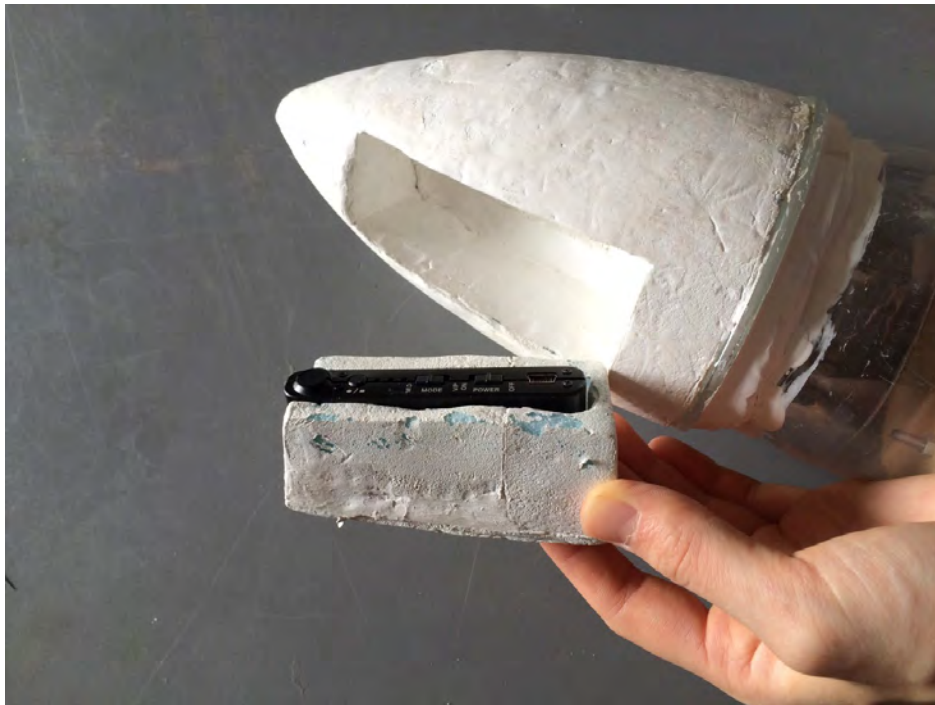
図 4.6 ノーズコーンの構造
