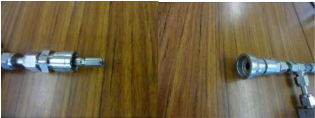
図 16. クイックコネクツ・ステム(左), クイックコネクツ・ボディ(右)
