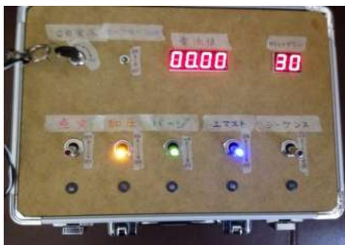
図 12. CB(パージスイッチは燃焼実験でのみ使用する)
