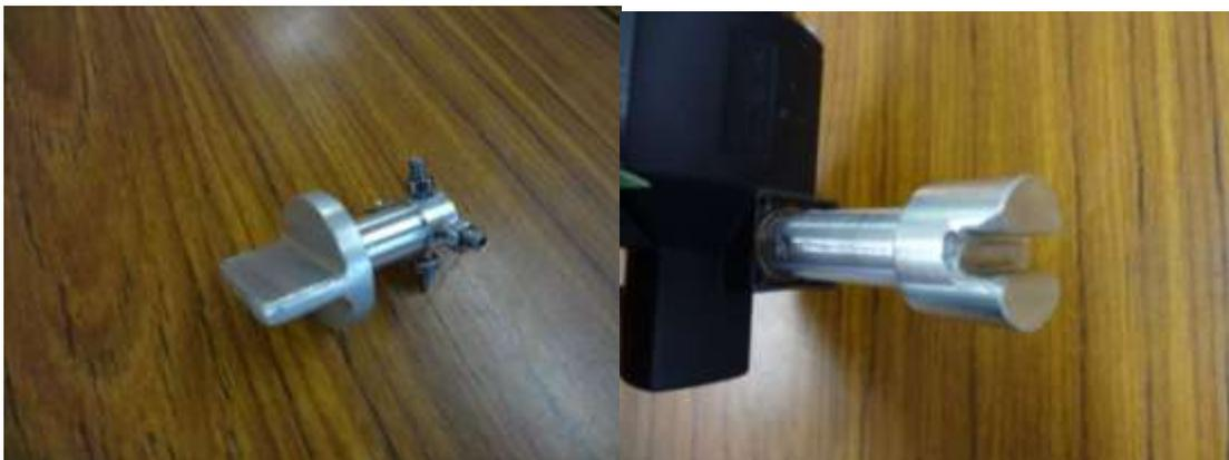
図 18. バルブアダプター(左), アクチュエータアダプター(右)
