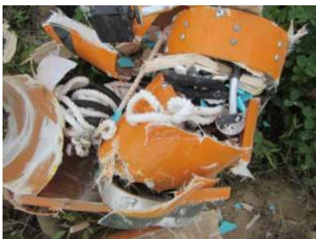
図 3.2.7 回収機構・電子部
