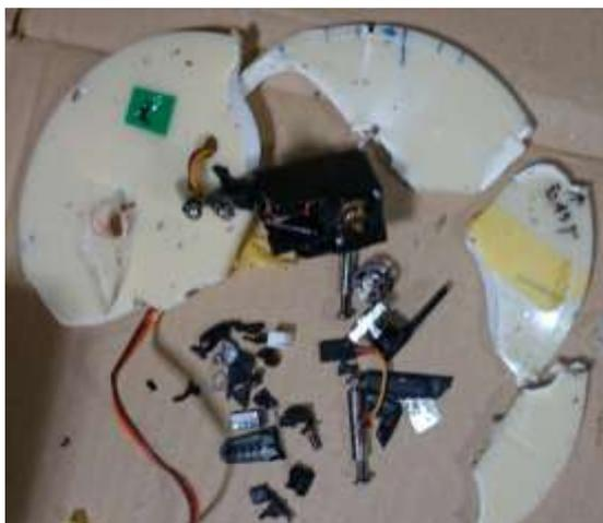
図 13.1.1.1.4 回収後 サーボ及び固定板
