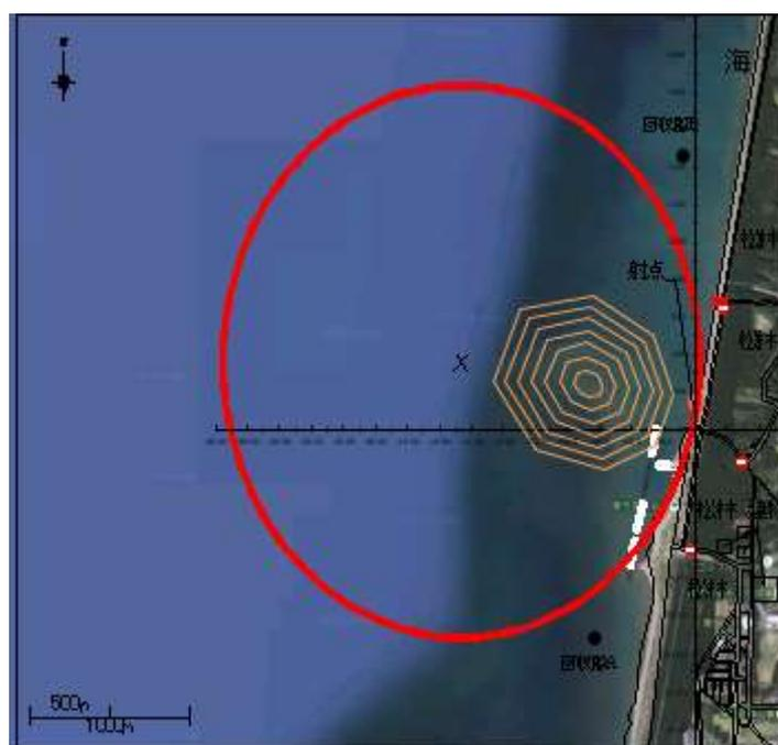
図 7.1.4 減速落下時の落下分散(東海大学シミュレーション)
