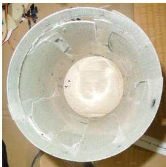
図 13.1.1.1.3 回収後 開放下部 ボディーチューブ エンジン側から
